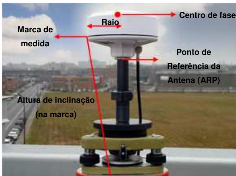
Parâmetros de decalagem vertical, de raio de antena, e de centro da fase de uma antena GNSS
