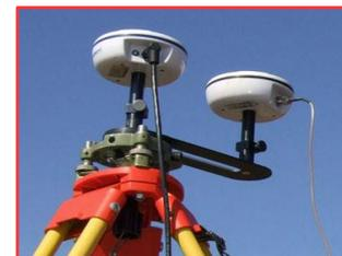
**EZBar**, colocada no marco da base, separa o centro das antenas de **exatamente 20 cm**.
