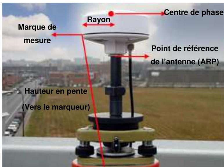
Différent paramètres d'une antenne GNSS
