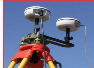
La **EZBar** installée au site de base, sépare les 2 centres d'antenne d'**exactement 20 cm**.
