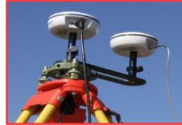
Una **EZBar**, en el sitio de base, separa los centros de las antenas de **exactamente 20 cm.**
